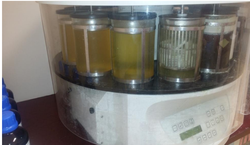
Figure8 : fixation au formol, déshydratation et paraffinage.
